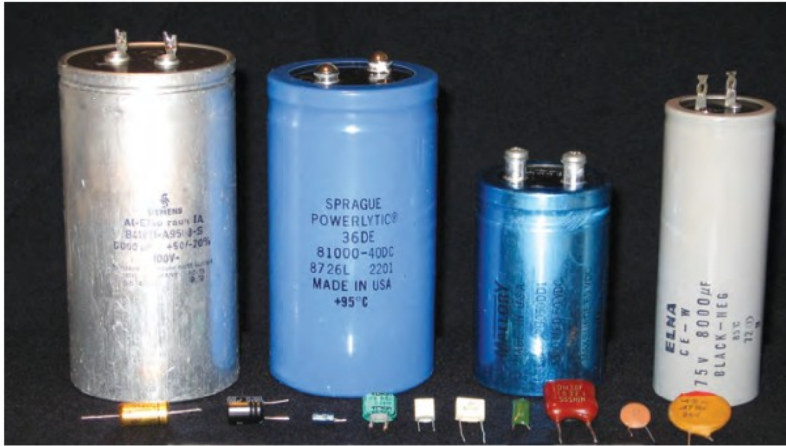
■ الشكل 15-6 تبين الصورة المجاورة أنواعاً مختلفة من المكثفات.
