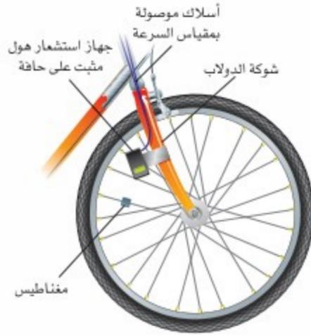
يستخدم المجس الذي يعمل وفق تأثير هول في مقياس سرعة الدراجة الهوائية لقياس سرعتها.
