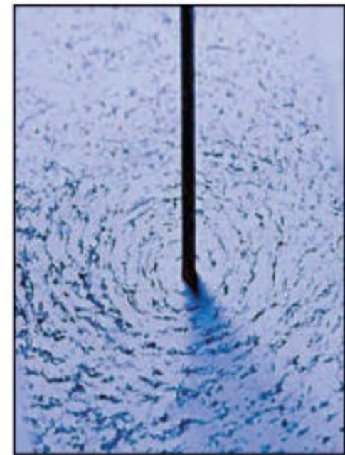
■ الشكل 9-1 يظهر المجال المغناطيسي حول سلك يمر فيه تيار كهربائي ويخترق قرصاً كرتونياً في صورة دوائر متحدة المركز من برادة الحديد حول السلك.
