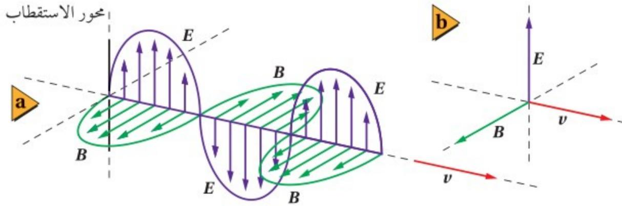
■ الشكل 7-3 أجزاء من المجالين الكهربائي والمغناطيسي المتولدين بواسطة الهوائي قد تبدو في لحظة ما، كما هو موضح (a). لاحظ أن المجالين الكهربائي والمغناطيسي متعامدان، وعموديان على اتجاه سرعة الموجة  $v$  (b).
