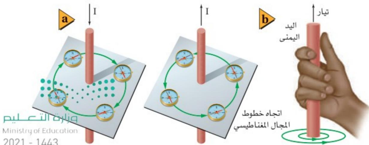
■ الشكل 10-1 ينعكس اتجاه المجال المغناطيسي الناتج عن مرور تيار في سلك موصل مستقيم عندما ينعكس اتجاه التيار المار فيه (a). ويُحدّد اتجاه المجال المغناطيسي الناتج عن سلك مستقيم يحمل تياراً باستخدام القاعدة الأولى لليد اليمنى (b).
