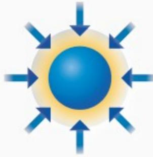
في العزل بالقصور الذاتي، يسخَّن الضوء أو الأشعة السينية الناتجة عن الليزر سطح الكريات بسرعة. مكوّنة غلافًا يحيط بالبلازما. أما الوقود المتبقي فيضغَط بنفخ المواد السطحية الساخنة.
