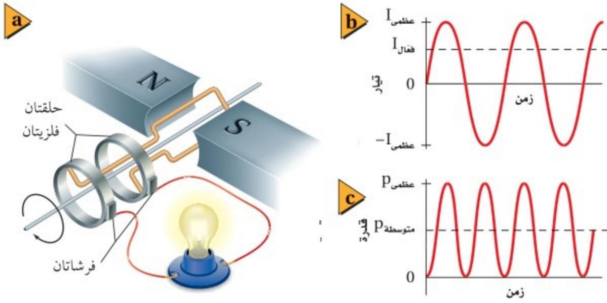
■ الشكل 2-8 ينقل مولد التيار المتناوب التيار إلى دائرة خارجية عن طريق فرشاتين تلامسان الحلقتين (a). التيار المتناوب الناتج يتغير مع الزمن (b)، تكون القدرة الناتجة دائماً موجبة، كما تكون أيضاً دالة جيبيية (c).
