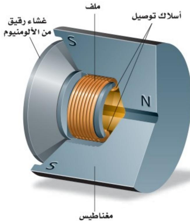
■ الشكل 4-2 يبين الرسم حركة ملف الميكروفون؛ حيث يتصل غشاء رقيق من الألومنيوم بملف موضوع داخل مجال مغناطيسي. وعندما يهتز الغشاء بفعل موجات الصوت يتحرك الملف في المجال المغناطيسي مولدًا تيارًا كهربائيًا يتناسب مع موجات الصوت.
