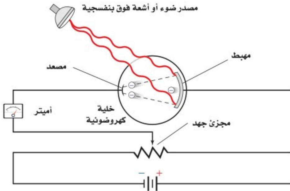
■ الشكل 3-4 يمكن قياس الطاقة الحركية العظمى للإلكترونات المتحررة من المهبط باستخدام هذا الجهاز؛ حيث يقيس الأميتر التيار المار في الدائرة. وبتعديل مجزئ الجهد يمكن للشخص الذي يجري التجربة تحديد فرق الجهد الذي يصبح عنده التيار المار في الدائرة صفراً. عندها يمكن قياس الطاقة الحركية العظمى الممكنة للإلكترونات المتحررة.
