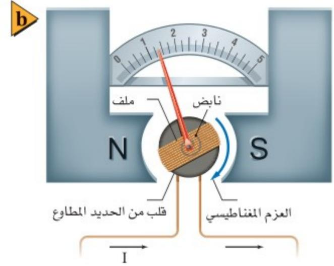
■ الشكل 19-1 إذا وضعت حلقة سلكية يمر فيها تيار في مجال مغناطيسي فسوف تدور (a). يدور ملف الجلفانومتر بالتناسب مع مقدار التيار (b).
