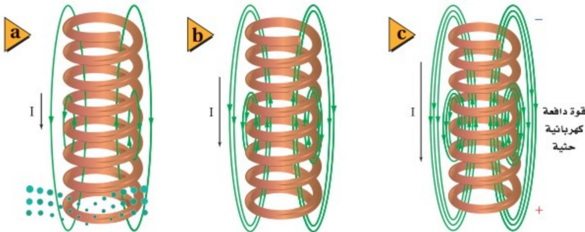
■ الشكل 14-2 بزيادة التيار في الملف من (a) إلى (c) يزداد المجال المغناطيسي المتولد بواسطة التيار أيضاً. هذه الزيادة في المجال المغناطيسي تولد قوة دافعة كهربية حثية تعاكس اتجاه التيار.
