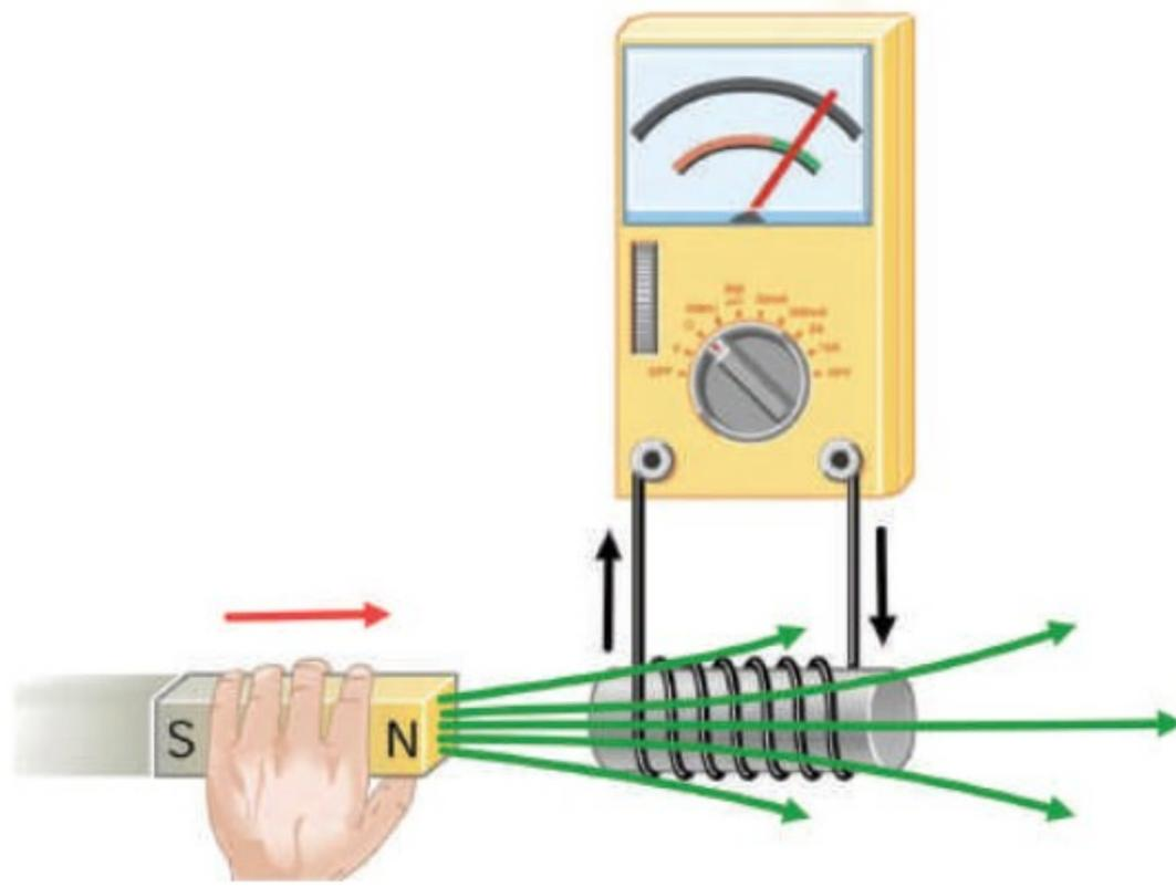
■ الشكل 11-2 يؤدي اقتراب القطب الشمالي للمغناطيس من الملف إلى مرور تيار حثي في الملف. ويمكن توقع اتجاه هذا التيار المتولد بواسطة قانون لنز.
