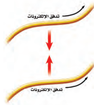
الشكل ١٢ يتجاذب السلكان اللذان يسري فيهما تياران كهربائيان في الاتجاه نفسه، كأقطاب المغناطيسية المختلفة تماماً.
