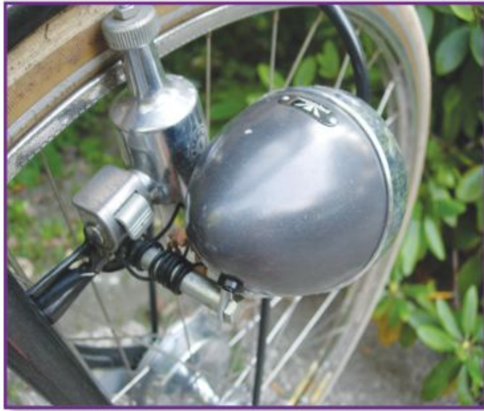
يتصل المولد الكهربائي بعجلة الدراجة
