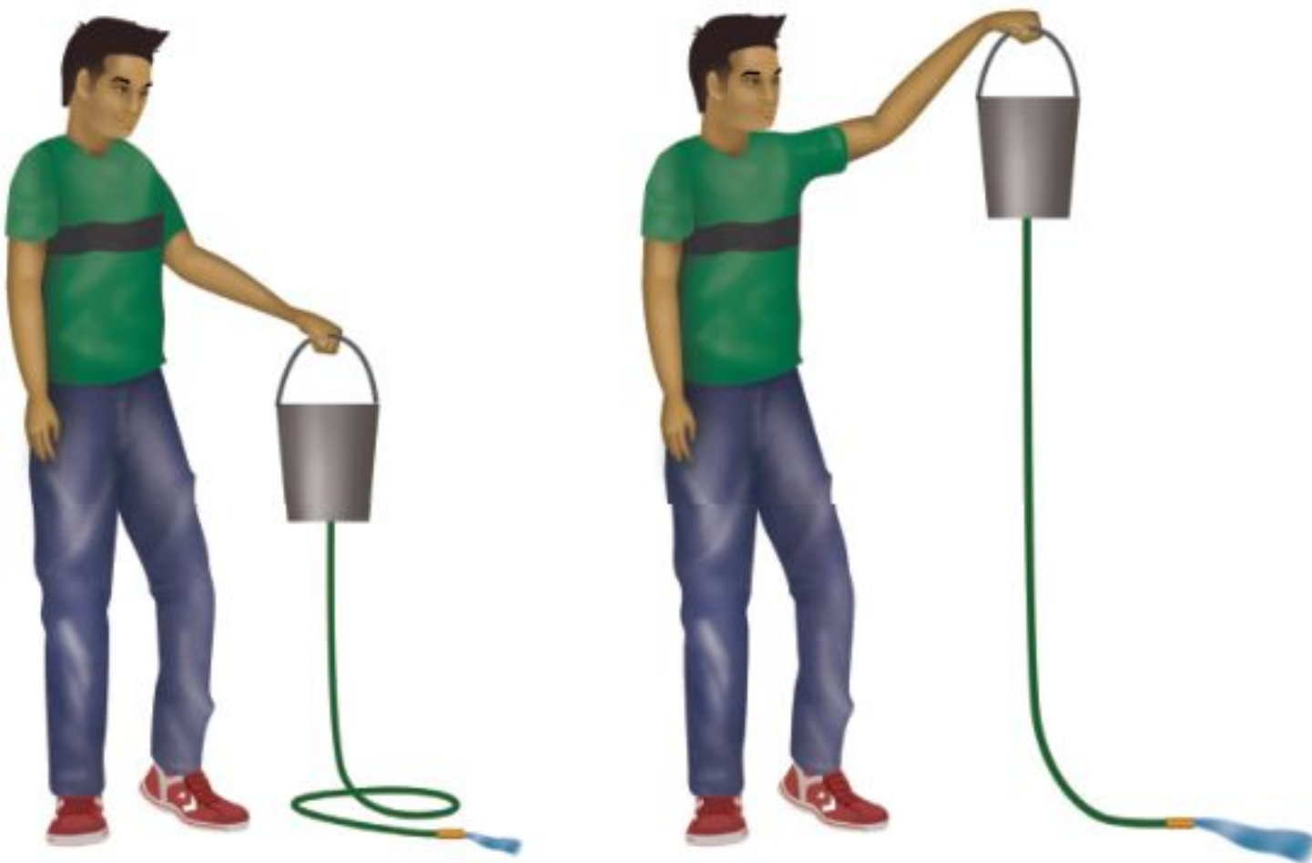
الشكل ١٠ عند رفع الدلو إلى أعلى يزداد مقدار طاقة وضع الماء، مما يسبب زيادة سرعة تدفق الماء الخارج من الخرطوم.
