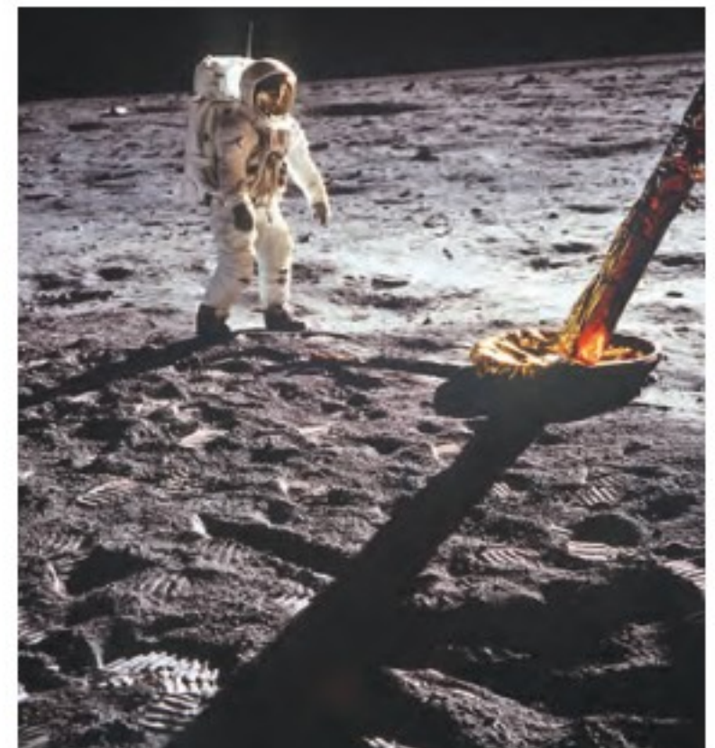
الشكل 2-6 إن رائد الفضاء ومركبته يولدان ضغطاً على سطح القمر. إذا كانت كتلة المركبة 7300 kg تقريباً، وتستقر على أربعة أقدام قطر كل منها 91 cm، فما مقدار الضغط الذي تؤثر به على سطح القمر؟ وكيف تستطيع أن تقدر الضغط الذي يؤثر به رائد الفضاء.
