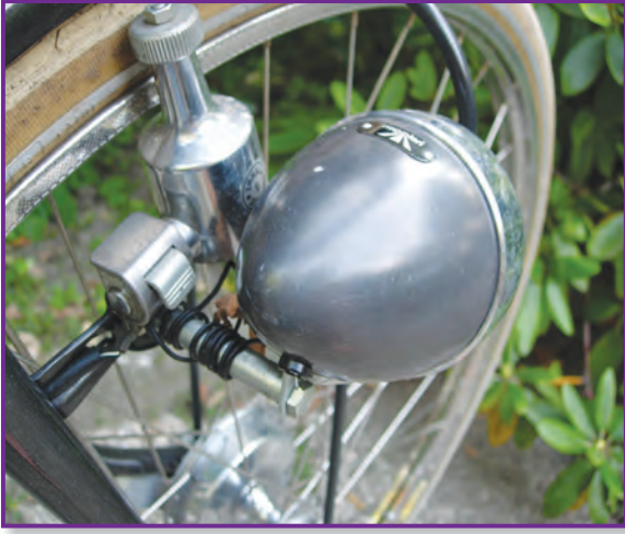
يتصل المولد الكهربائي بعجلة الدراجة
