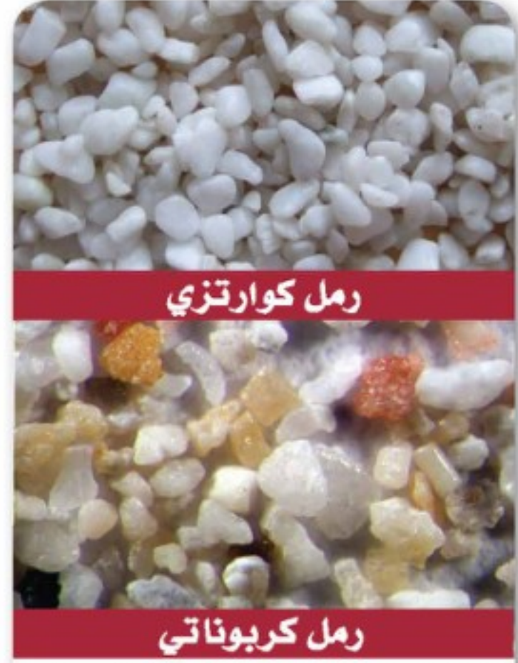
الشكل 9-3 حبيبات الرمل الكربوناتي المنقولة من مسافات قريبة حادة، مدببة الحواف، وليس لها استدارة أو نعومة كحبيبات الرمل الكوارتزي المنقولة من مسافات بعيدة.
