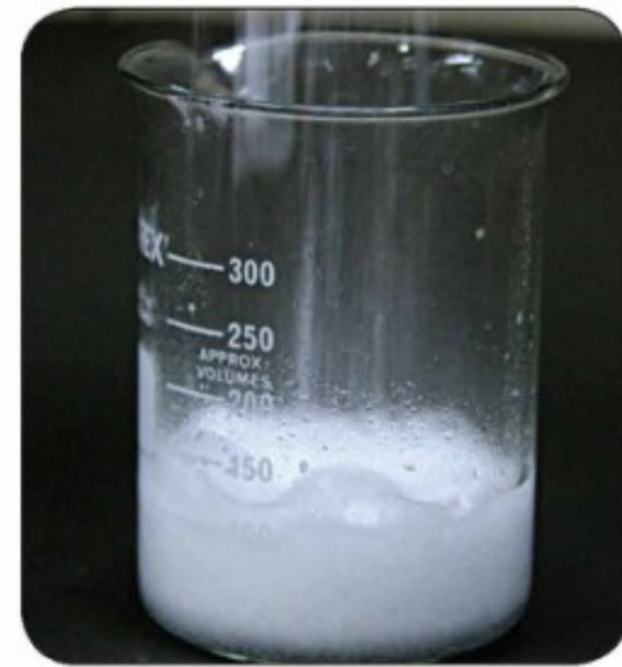
الشكل 1 تتكون فقاعات من غاز ثاني أكسيد الكربون عندما تضاف قاعدة صودا الخبز إلى حمض الخل.
