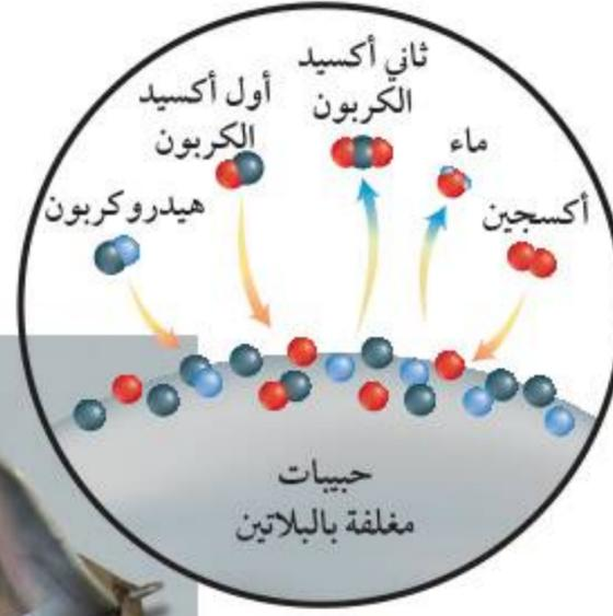
**الشكل ١٩** تساعد المحفزات المحوّلة على إتمام عملية احتراق الوقود. فتمر غازات العادم الساخنة على سطح الحبيبات المغلفة بالفلز، فتتحول الهيدروكربونات وأول أكسيد الكربون إلى ثاني أكسيد الكربون والماء.
