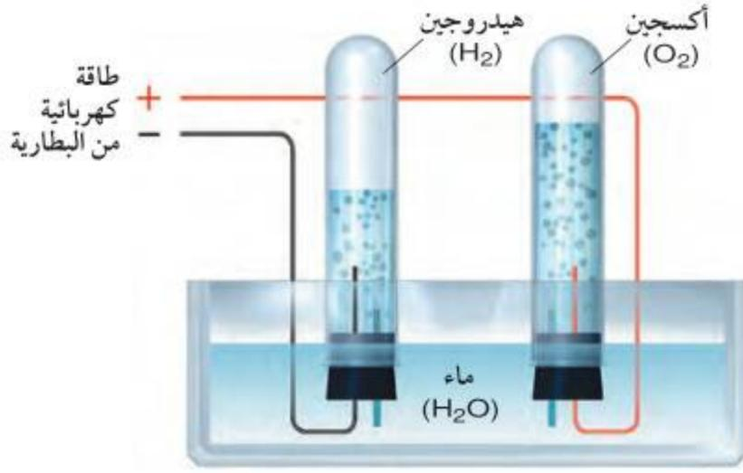
١٢. توضح الصورة أعلاه عملية التحليل الكهربائي للماء، حيث يتفكك جزيء الماء إلى هيدروجين وأكسجين. أي المعادلات الآتية يعبر بصورة صحيحة عن هذه العملية؟
