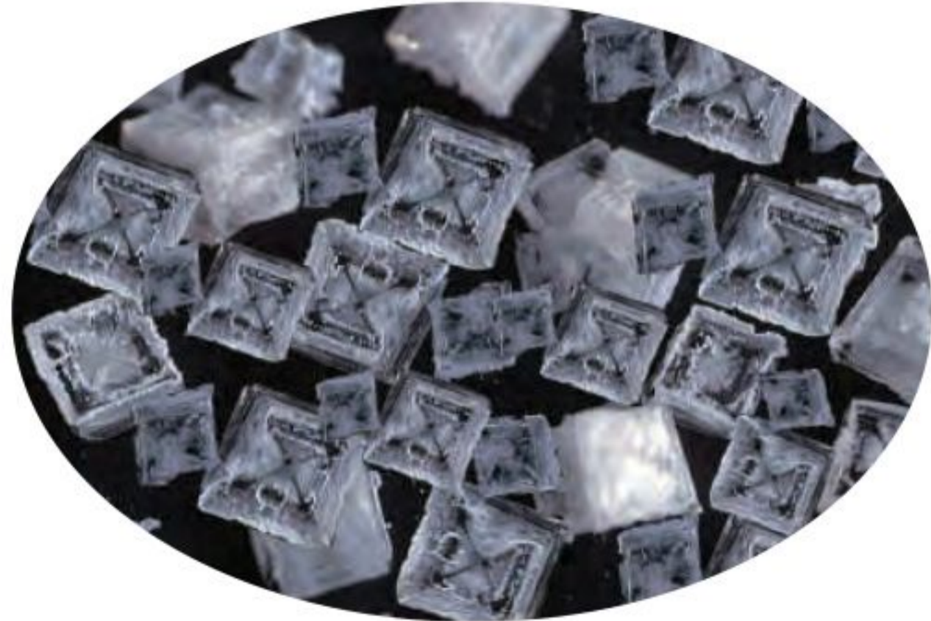
هذا الشكل المكبر يوضح الشكل المكعب لبلورات كلوريد الصوديوم
